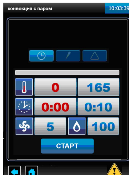
Рис.17 Меню режима « КОНВЕКЦИЯ С ПАРОМ »
