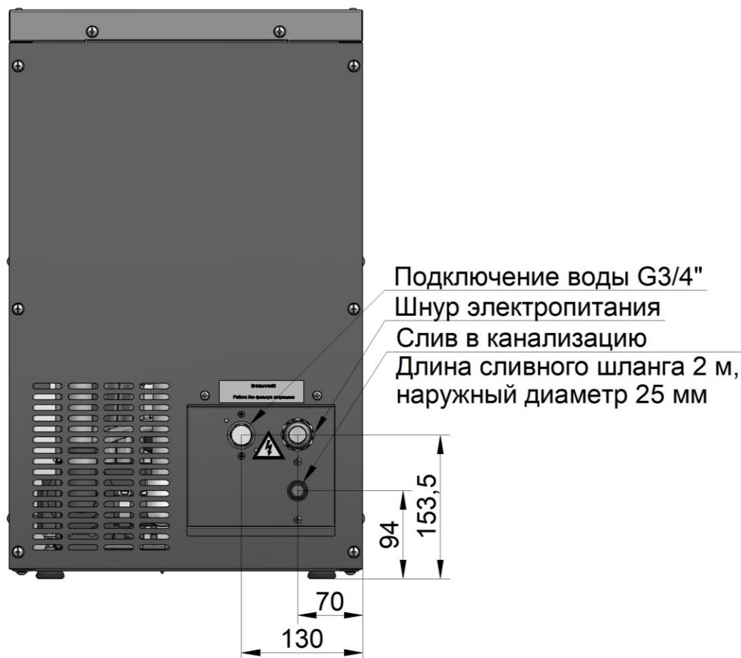
Рис. 5 Схема подключения льдогенератора
