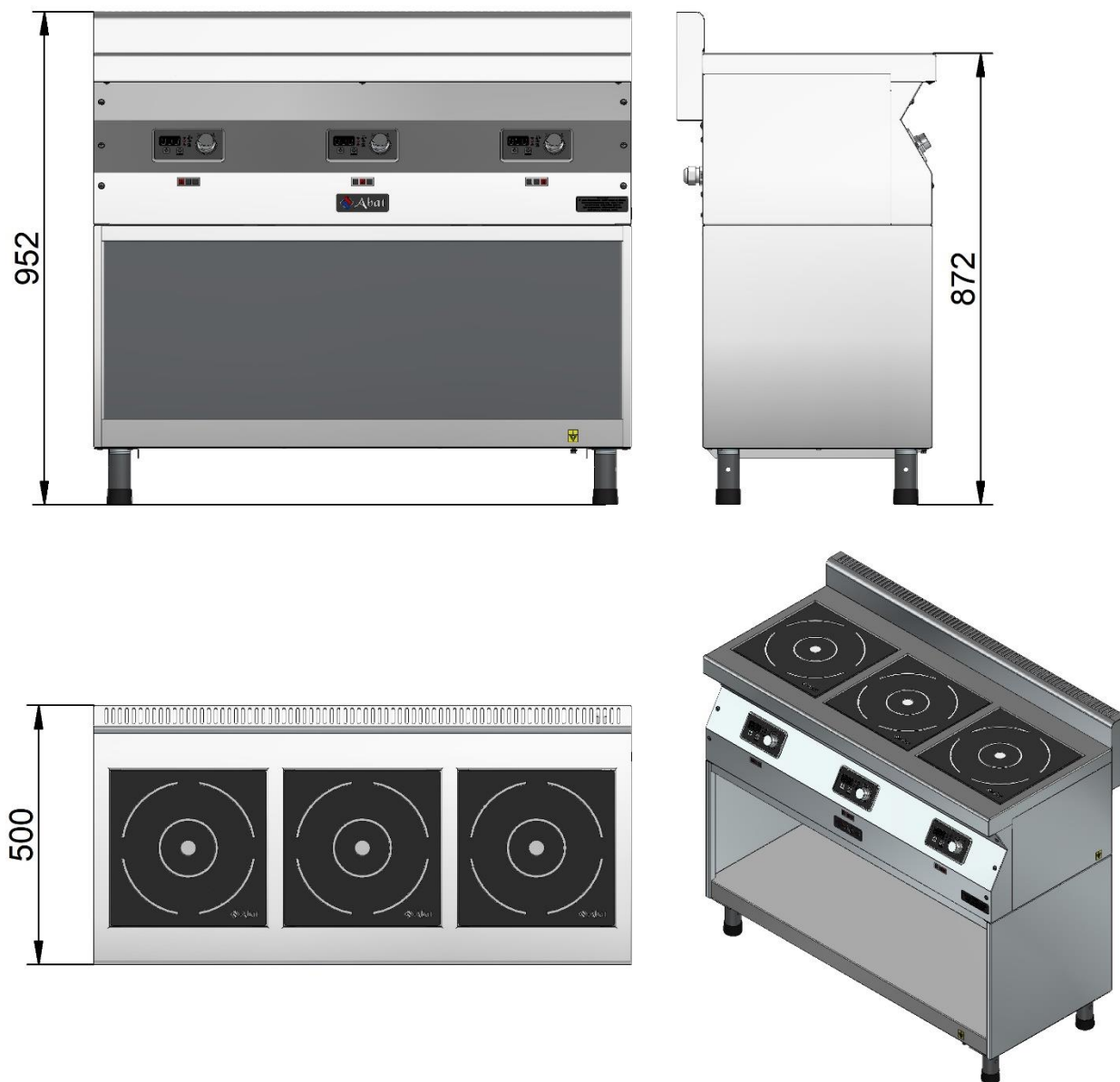
Рис. 5. Плиты КИП-35Н-3,5, КИП-35Н-5,0 с подставкой (модулем нижним) МН-35
