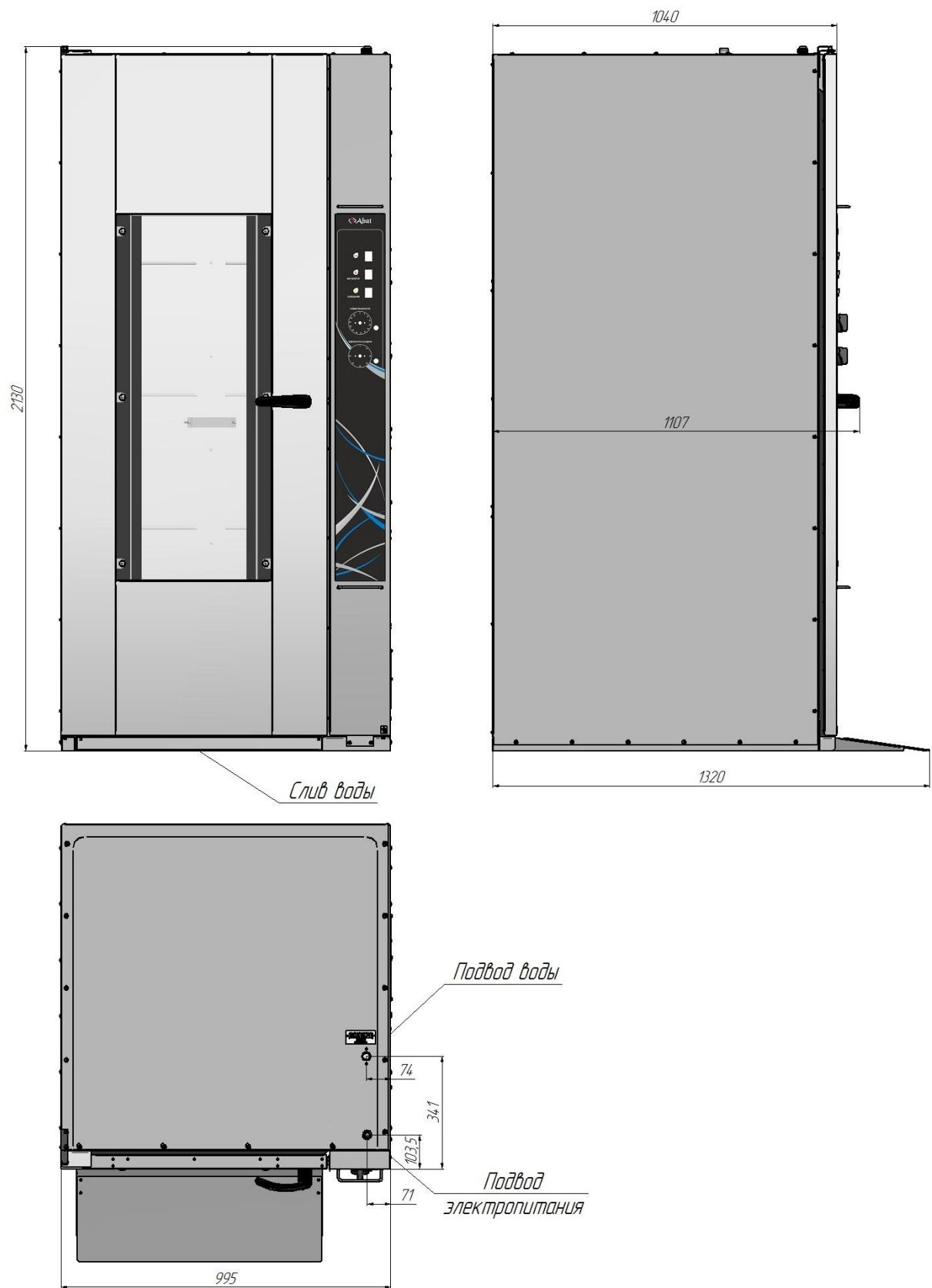
Рис.2 Шкаф расстоечный тепловой ШРТ-18М.
